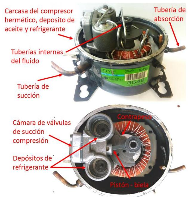
**Figura 2** Partes principales del compresor recíprocante
